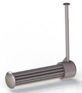
Нагреватели битума Т-2 оборудованы цифровыми датчиками температуры для определения  $t^\circ\text{C}$  битума (мазута) на дне цистерны, что позволяет получить точную информацию о времени слива. Если слив начать не полностью разогретым битумом, то на стенках останется значительное количество битума. Избыточное же время разогрева увеличивает простой и расход энергоресурсов.
